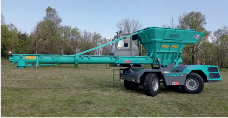
Manœuvrabilité maximale grâce à la direction active des quatre roues motrices
