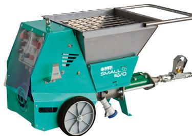
Débit de 0.8 à 14 l/min grâce à la vitesse variable de la machine
