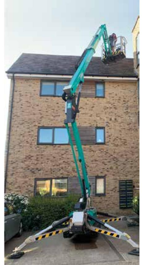
Le bras articulé avec JIB et la rotation du panier de  $\pm 62^\circ$ , ainsi que le pivotement de la tourelle de  $360^\circ$  (non continu), permettent un positionnement optimal de la machine dans toutes les situations de travail.
