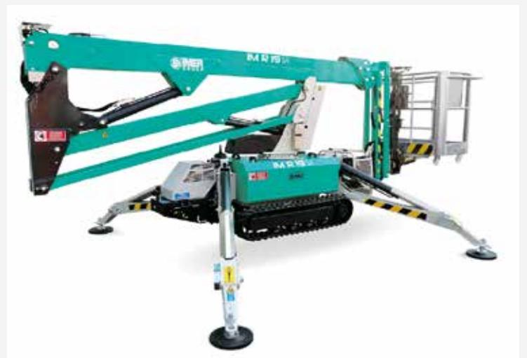
Taille compacte, avec un encombrement limité des stabilisateurs. La stabilisation automatique standard permet un positionnement optimal et rapide de la machine.
