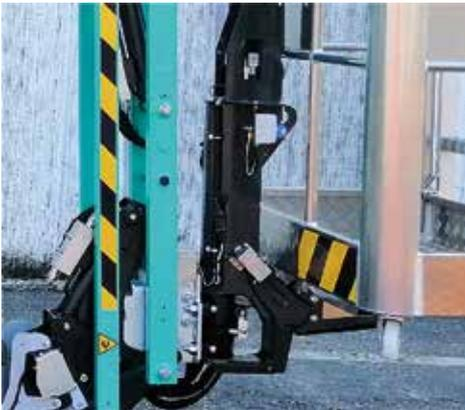
Compacité de l'ensemble flèche recevant le capteur de pesage et le système de montage rapide du panier.
