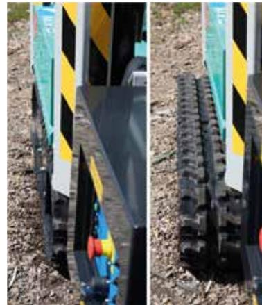
Largeur des chenilles réglable hydrauliquement : plus de stabilité et de traction pour se déplacer sur le chantier ou en terrain accidenté ou pour les passages étroits.
