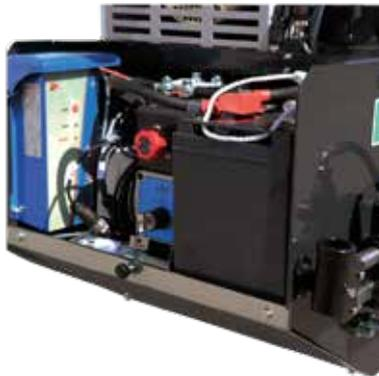
Pompe de secours manuelle et compartiment contenant la batterie et le contrôle de l'électropompe de secours et de la connexion de la batterie.
