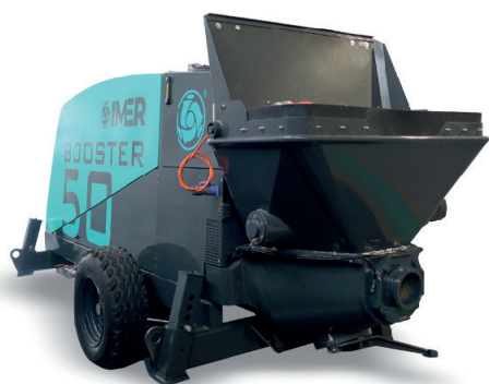
Grande trémie de 350 L avec agitateur interne
