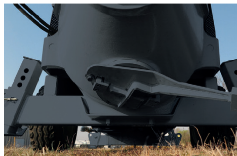
Porte de déchargement de la trémie.
