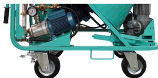
Passage de fourche anti-basculement pour la prise par chariot élévateur.
