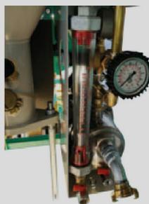
Système hydraulique en laiton anti-oxydation. Disposition réfléchie des composants pour améliorer le drainage de l'eau en hiver.
