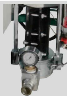
Groupe de pompage à stator et rotor R8 et turbo-malaxeur standard.
