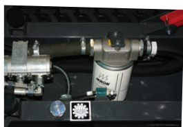
Réservoir d'huile hydraulique incorporé au châssis
